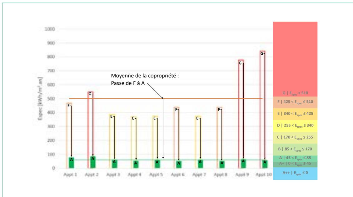
Fig. 52. Niveaux de consommation spécifique (et positions sur l'échelle certificative wallonne) des logements du bâtiment Fil Rouge – après la troisième étape
