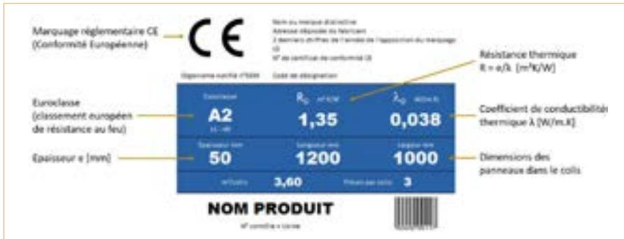
Fig 32. Guide de lecture de l'étiquette d'un isolant thermique (Source : ACERMI, Association pour la certification des matériaux isolants (France))
